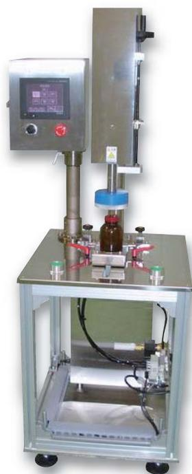
サーボモーターを搭載し、キャッピング中、常にトルクを管理し、設定トルクに到達するまで締付け、実際の締付けトルクをデジタル表示します。
